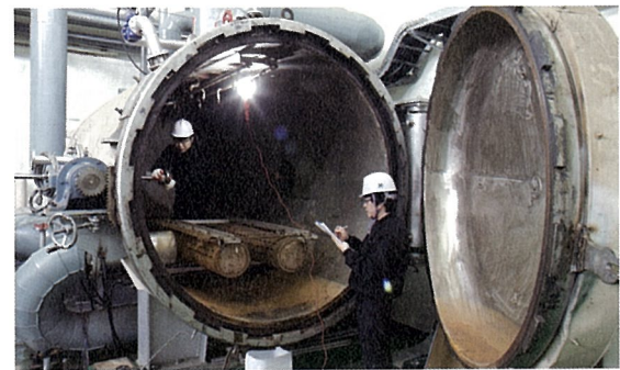
원자력 발전소의 기기검증을 위한 설계기준사고시험 설비
