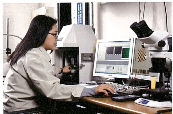
원자현미경을 이용한 기계적 물성 측정
