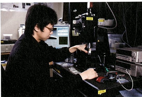
미소 인장 시험기를 이용한 전기 · 기계 복합 특성 측정
