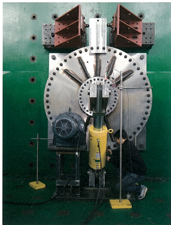
풍력발전기 날개 피치 베어링 시험
