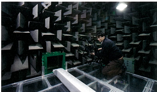
초고속 자기부상열차 공력 소음원 위치 추정을 위한 축소모형 실험
