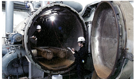
원자력 발전소의 기기검증을 위한 설계기준사고시험 설비
