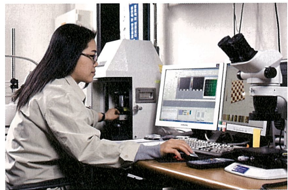
원자현미경을 이용한 기계적 물성 측정
