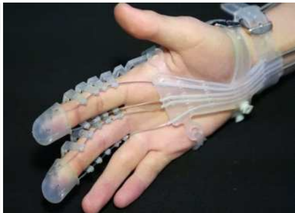
<그림 30> 서울대학교의 Wearable Hand Exo-Glove Poly 64)
