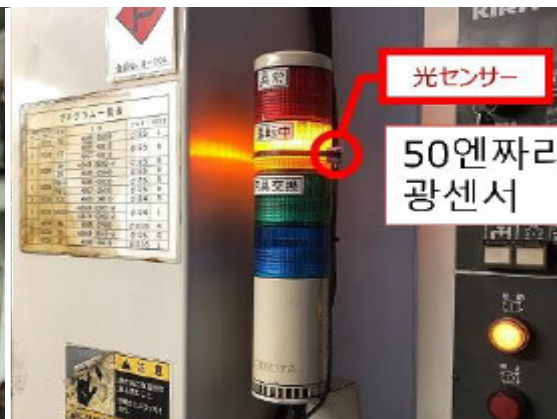
<그림 10> 50엔짜리 광센서를 활용한 아사히철공 사례 15)
