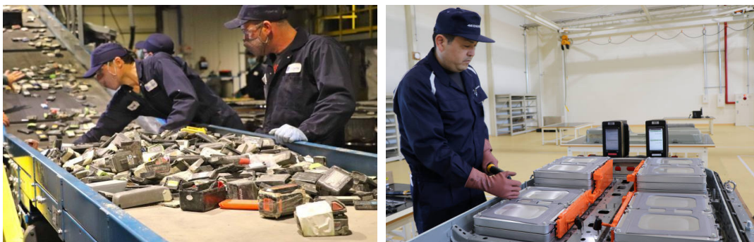
<그림 13> 미국 Li-cycle社의 폐배터리 선별(좌) 및 일본 4R-Energy社 폐배터리 재사용을 위한 잔존용량 측정(우)
