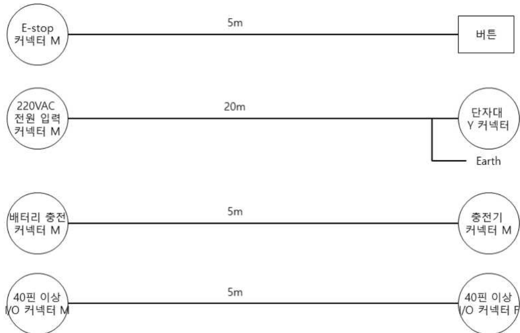
그림 6 외부 케이블 제작 사양
