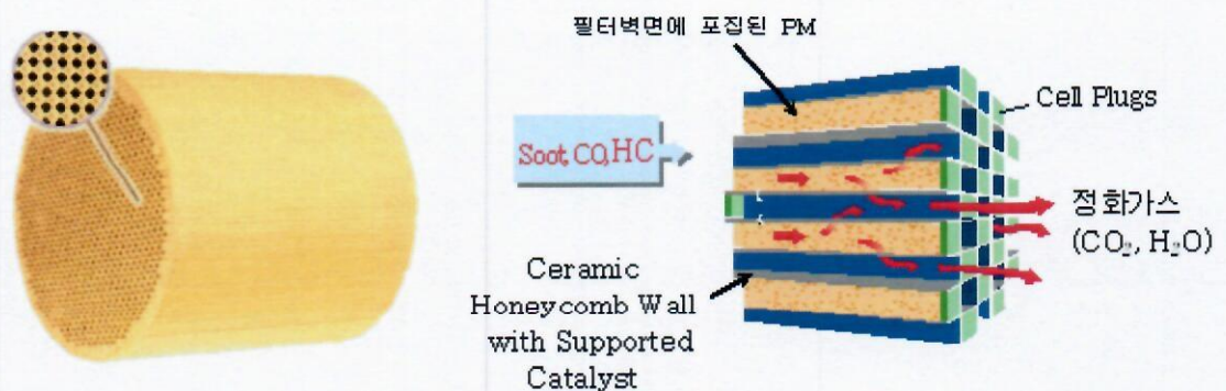
그림 2. Ceramic Honeycomb Wall Flow Filter와 PM 포집
