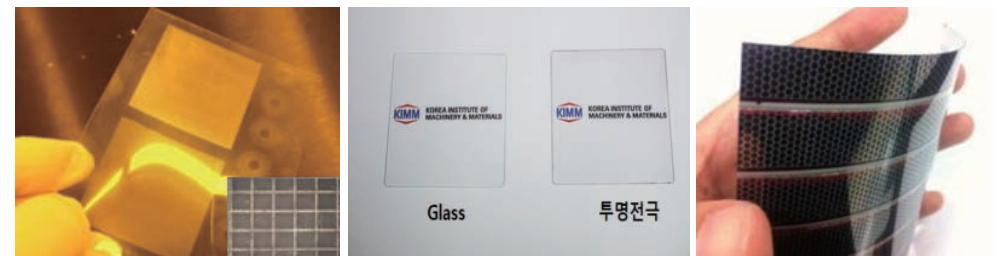
〈투명전극 제작 결과/투명전극필름/유연유기태양전지(응용)〉
