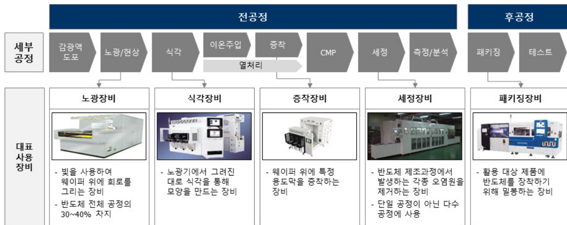
<그림 1> 반도체 제조공정 및 공정별 대표 사용 장비
