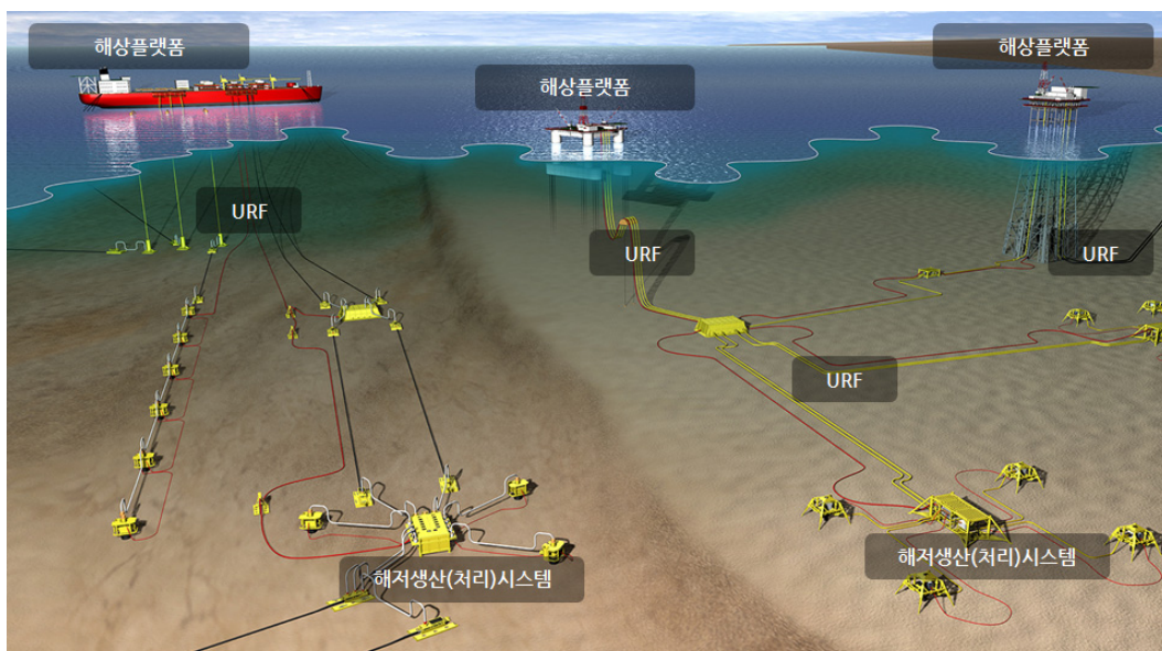
<그림 6> 해양플랜트의 구성: 해상플랫폼, 해저생산시스템, URF 16)
