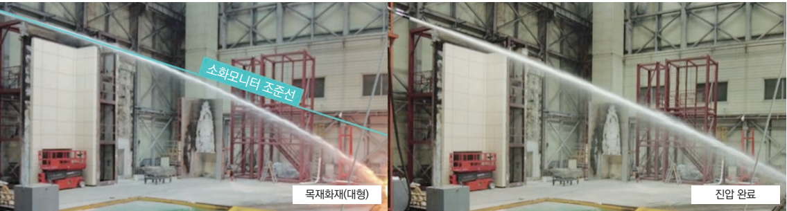
목재화재(대형) 진압 시험 예시
