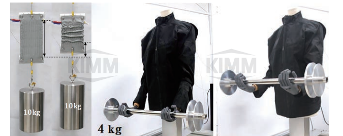
〈 20g 질량 옷감근육의 10kg부하 들기 〉 〈 의복형 웨어러블 로봇착용 마네킹의 4kg 바벨 들기 〉
