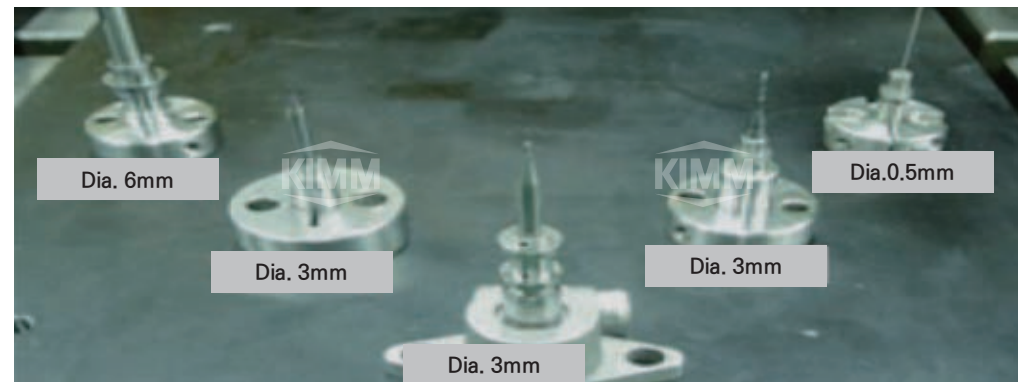
〈 SMA 공구 클램핑 시스템 프로토타입 〉
