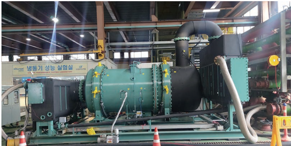
〈개발된 물 냉매 냉각 시스템 사진〉
