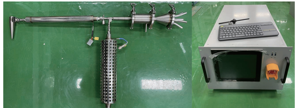
〈굴뚝 고정형 미세먼지(PM2.5, PM10) 연속 측정 장치 : (좌) 회석 샘플링 장치, (우) 제어반〉
