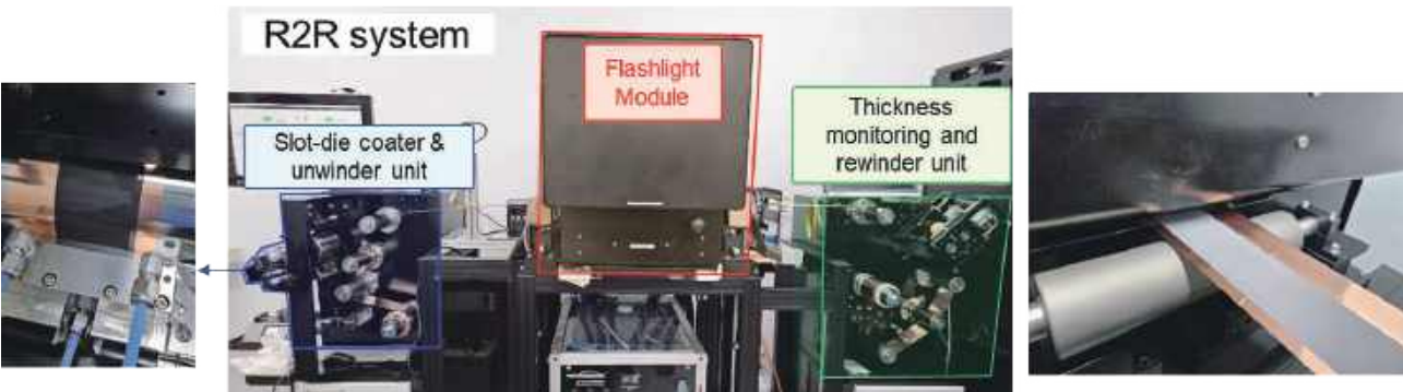
〈고성능 이차전지 전극 제조를 위한 롤투롤 플래시 복합 공정 시스템〉
