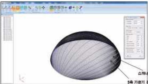
〈5축 가공기와 3축 레이저 스캐너 경로 분리/속도생성을 위한 CAM SW〉
