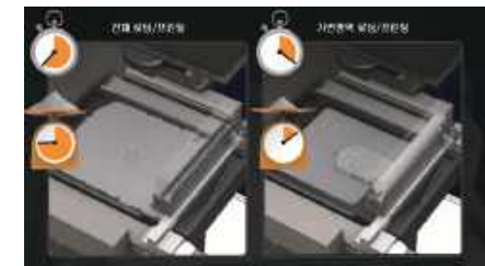
〈영역가변형 PBF기술을 통한 재료사용량 및 공정시간 단축 예시〉
