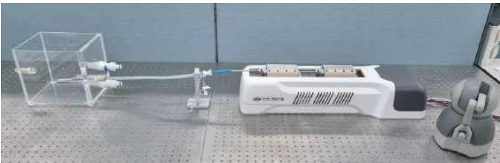
〈중재시술보조를 위한 유연 굴곡 카테터 및 원격 로봇 구동 시스템〉
