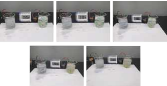
〈방수코팅 PCB의 염수환경 내구성 테스트, 일반PCB(좌), 방수코팅PCB(우)〉
