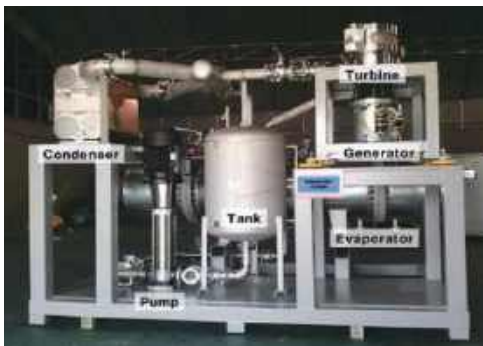
〈폐열회수 발전용 200kW급 ORC 시스템〉
