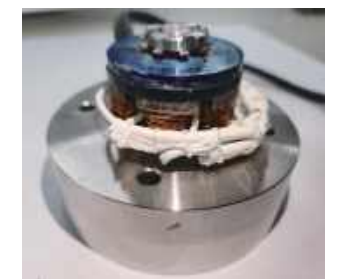
〈3D프린팅 Axial-Flux 모터〉
