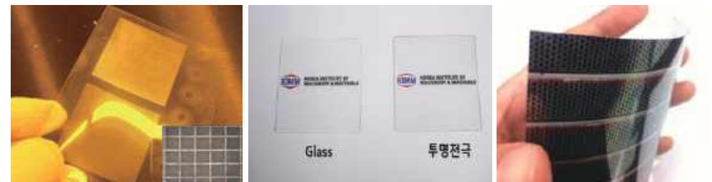
〈투명전극 제작 결과/투명전극필름/유연유기태양전지(응용)〉
