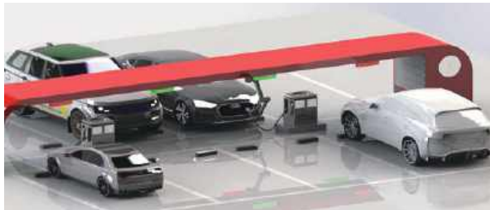
〈로봇 1대가 8대 차량 충전이 가능한 1:8 교각 구조〉
