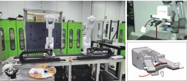
〈케이블 핸들링 전용 그리퍼 및 로봇 자동화 시스템〉
