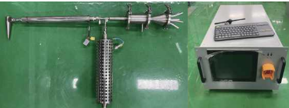
〈굴뚝 고정형 미세먼지(PM2.5, PM10) 연속 측정 장치 : (좌) 희석 샘플링 장치, (우) 제어반〉
