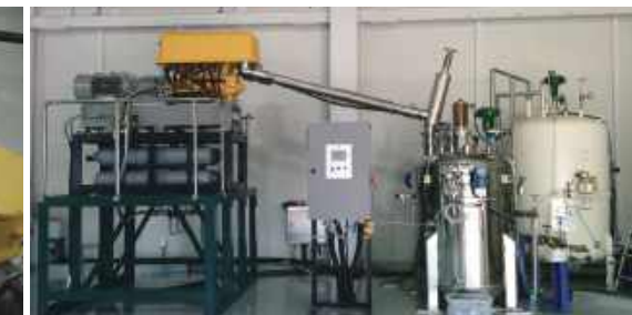
〈초전도 한류기 냉각시스템〉
