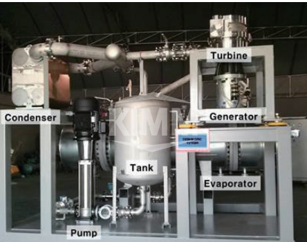
폐열회수 발전을 위한 200kW급 ORC 시스템
