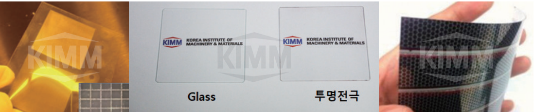
투명전극 제작 결과/투명전극필름/유연유기태양전지(응용)
