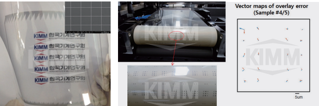
〈 리버스 옵셋 인쇄를 이용한 메쉬형 투명 전극 〉 〈 롤투롤 리버스 옵셋 인쇄된 중첩 인쇄 샘플 및 중첩 정밀도 계측 결과 (중첩 오차 벡터맵) 〉
