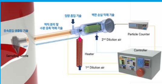
〈실시간 연속 미세먼지 및 초미세먼지 모니터링 장치 구성〉
